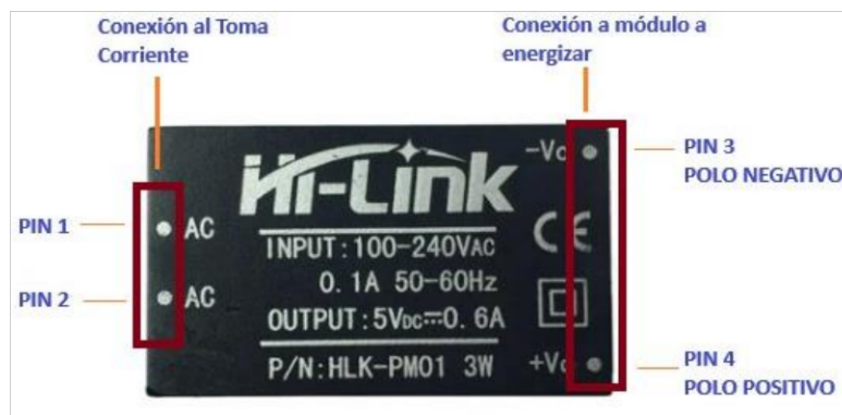
Figura 2.12 Diagrama de Conexión de Fuentes de Alimentación Conmutada [22].
