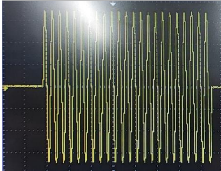
Figura 3.17. Control por Ciclo Integral con Banda de Histéresis ( n=23 y m=7 )
