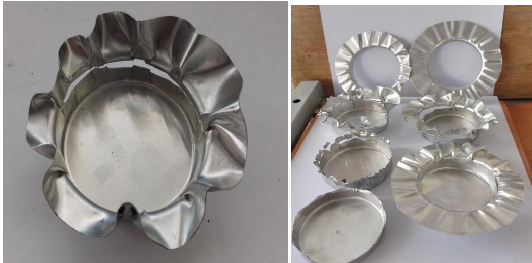
Figura 3.8 Piezas embutidas con fijación
