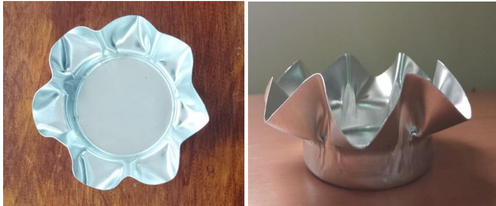
Figura 3.2 Pieza embutida sin fijación
