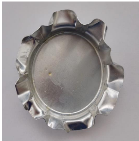
Figura 3.5 Piezas embutidas de diferente diámetro sin fijación
