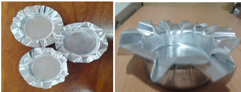
Figura 3.4 Piezas embutidas con fijación
