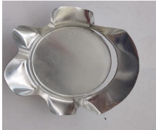
Figura 3.6 Piezas embutidas de diferente diámetro con fijación
