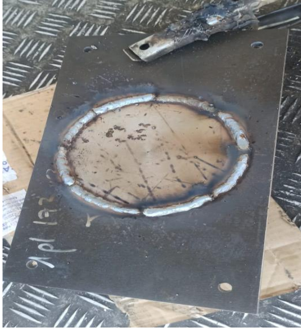
Figura 2.17 Proceso de soldadura de las placas de acero
