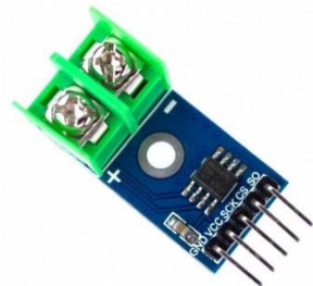
Figura 1.6. MAX6675 para termopar tipo k
