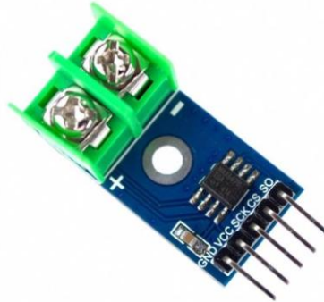
Figura 2.17. MAX6675 para termopar tipo k
