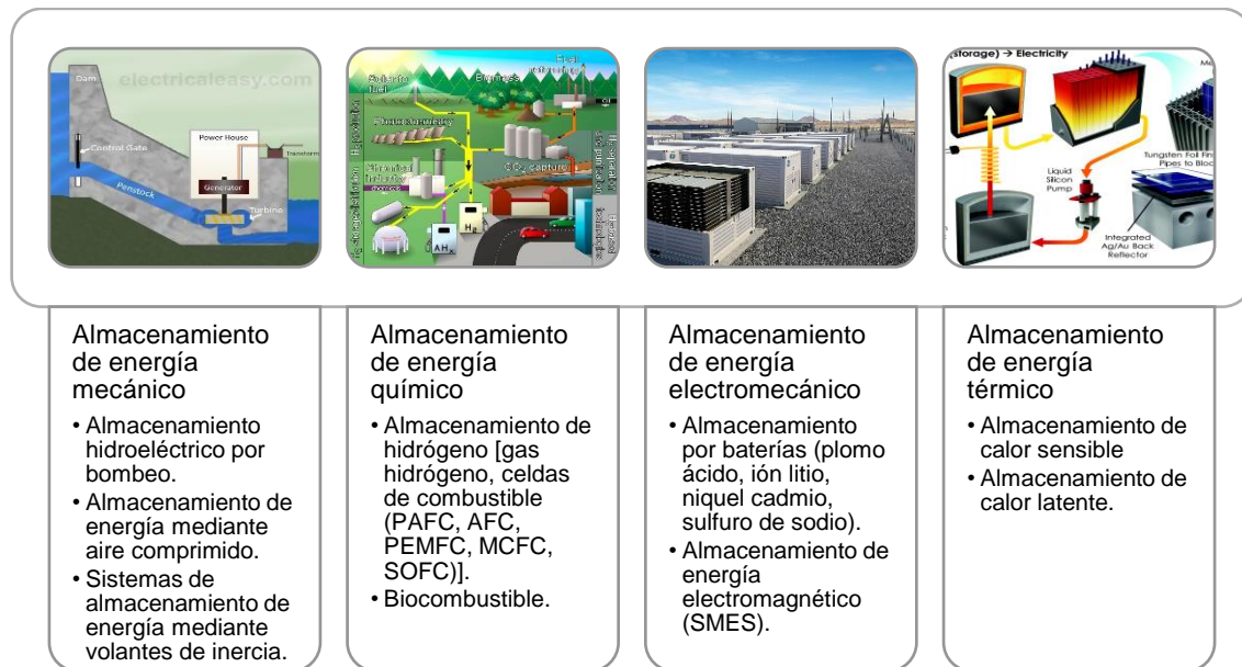
Figura 2.19 Varias clasificaciones de dispositivos de almacenamiento de energía. Adaptado de [21]
