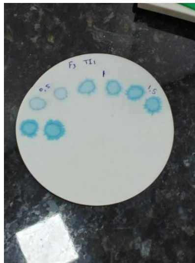
Figura 5: Prueba MBT para Fluido 1
