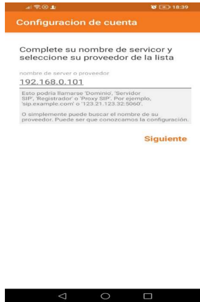
Figura 3.45. IP del sistema PBX
