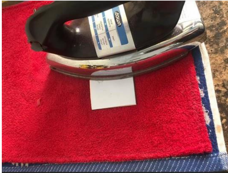
Figura 3.14. Planchado del Circuito en la Baquelita
