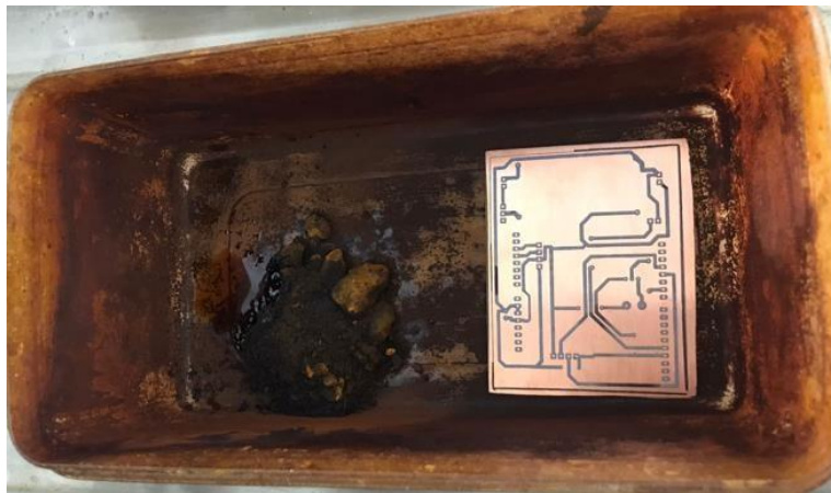
Figura 3.15. Colocación de Baquelita en Ácido
