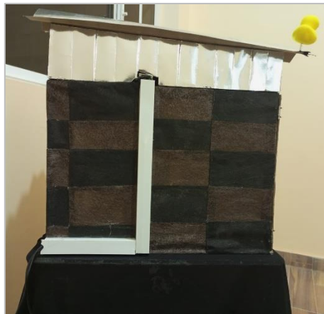
Figura 3.52 Ubicación de la canaleta en la maqueta
