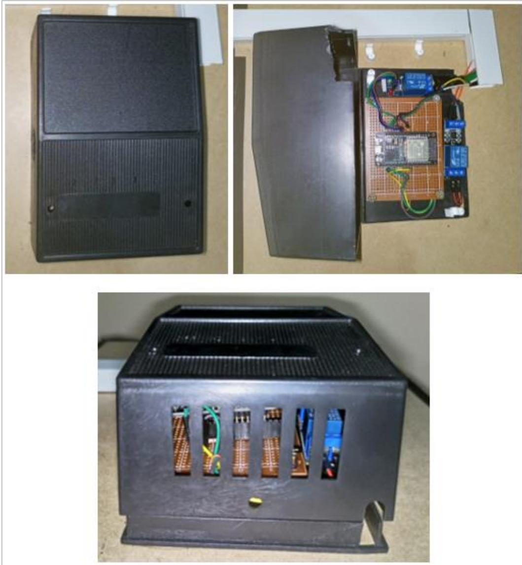
Figura 3.47 Caja contenedora del circuito
