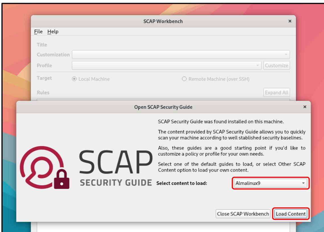
**Figura 3.9** Selección del sistema operativo y carga de la guía de seguridad
