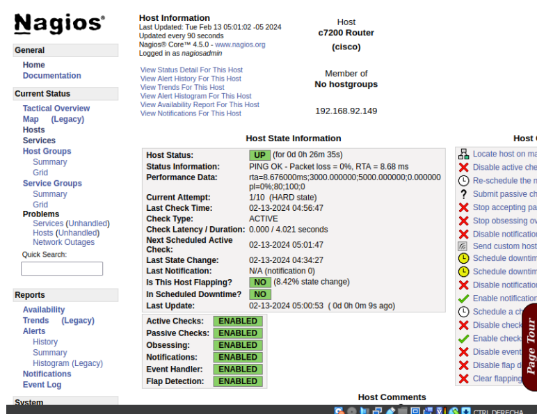
Figura 3.62 Comprobación Router Cisco
