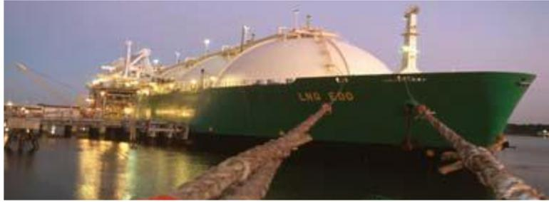
**Figura 2.8.** Buque con tanque esférico
