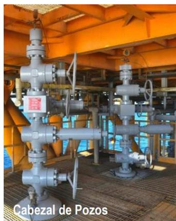
**Figura 2.38.** Cabezal de pozos de la Plataforma AMS - A
