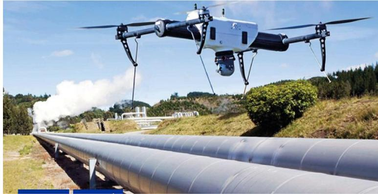
**Figura 2.26.** Dron realizando una inspección de tubería
