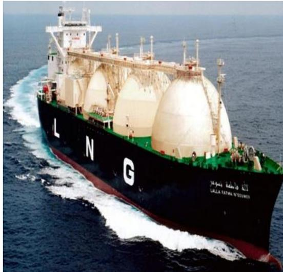
**Figura 2.7.** Buque GNL con tanques esféricos
