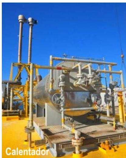
**Figura 2.40.** Calentador de la Plataforma AMS - A
