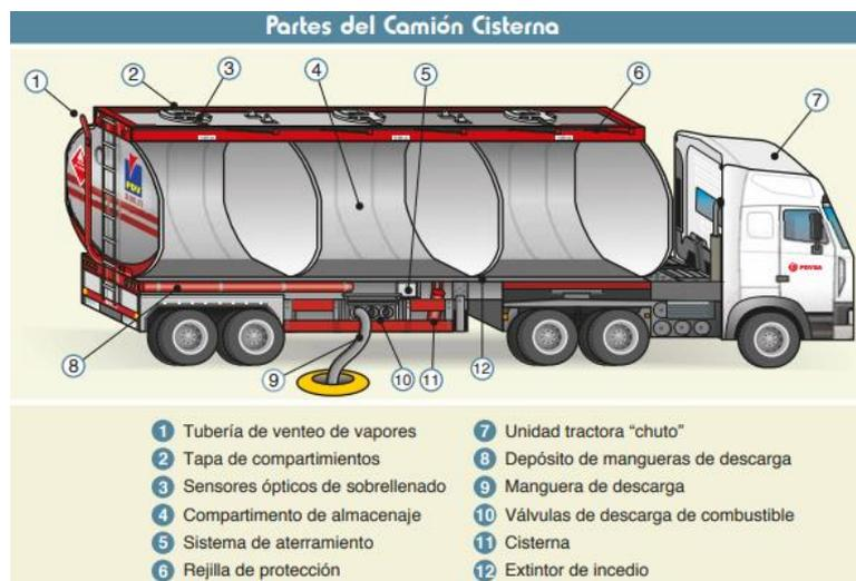
**Figura 2.16.** Partes del camión cisterna
