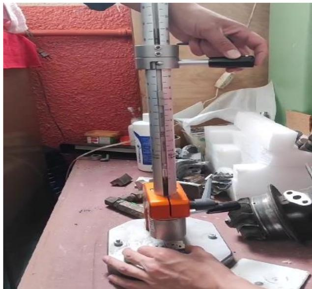
**Figura 2.24** Ensayo de impacto variable a una altura de 15 cm
