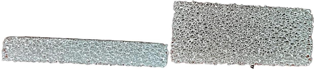
**Figura 2.10** Espuma metálica Duocel fabricada por la empresa ERG Aerospace
