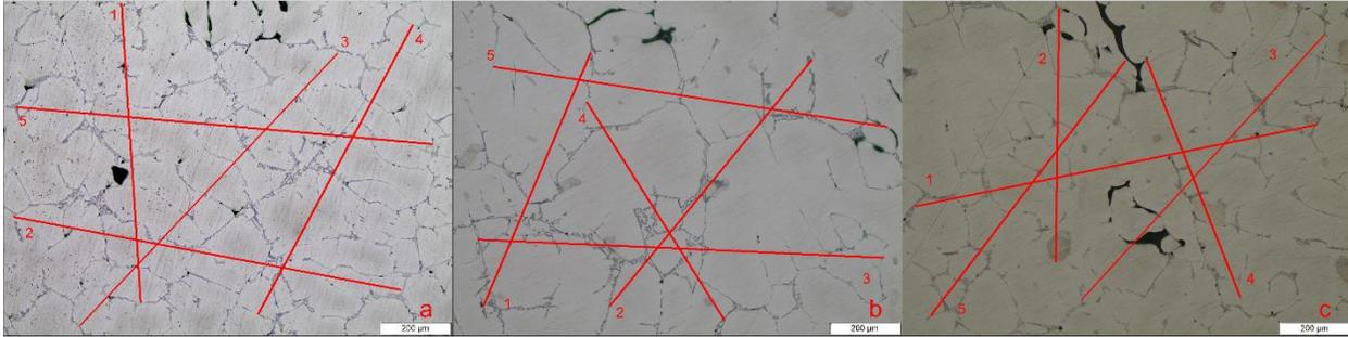
**Figura 3.3** Líneas de intersección en metalografías de espuma metálica.
