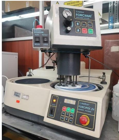
**Figura 2.4** Pulidora automática Forcipol 2V
