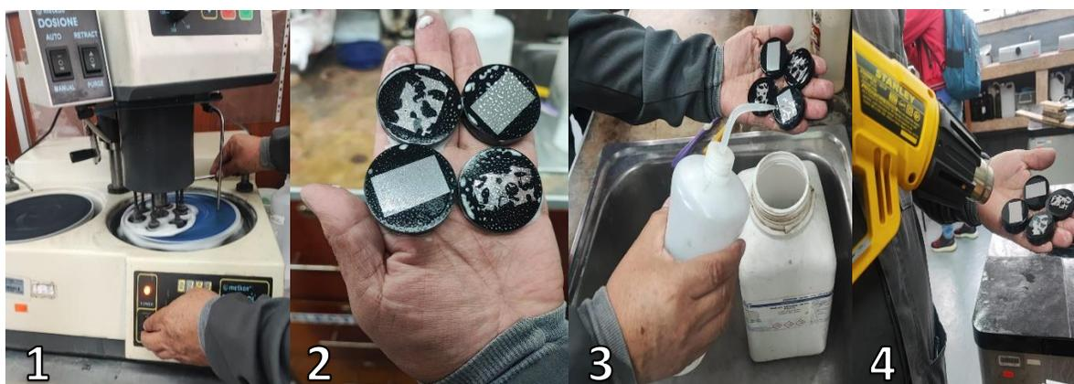
**Figura 2.17** Pulido de las probetas de aluminio
