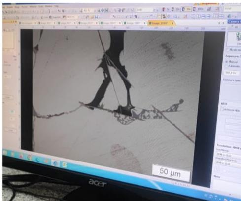
**Figura 2.20** Metalografía de la espuma metálica de aluminio
