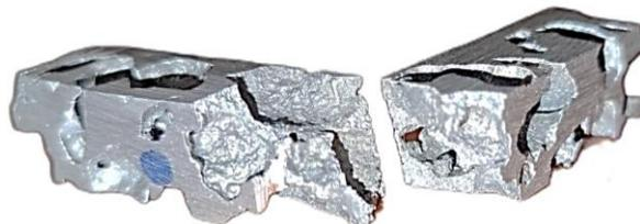
**Figura 3.4** Probeta de espuma metálica después de ensayo Charpy
