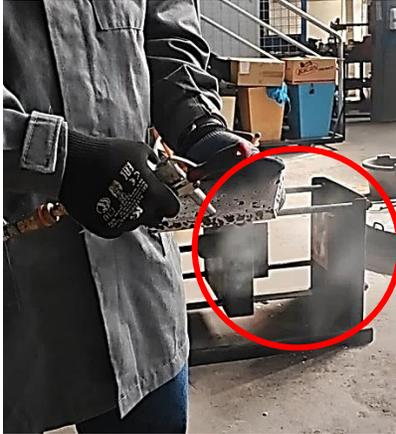
**Figura 2.12** Limpieza profunda de la espuma metálica
