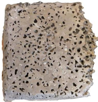
**Figura 2.9** Espuma metálica por el método de infiltración de metal fundido en preformas solubles
