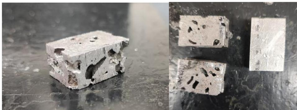
**Figura 2.15** Probetas de espuma y placa de aluminio cortadas
