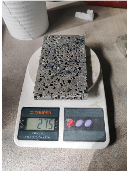
**Figura 2.28** Medición de la masa de la placa de espuma metálica
