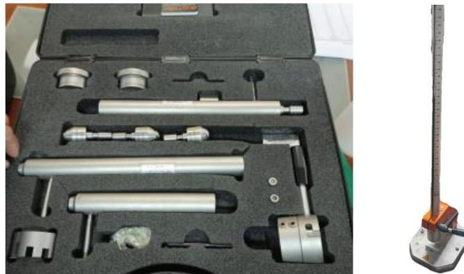
**Figura 2.5** Equipo comprobador de impacto variable Elcometer 1615
