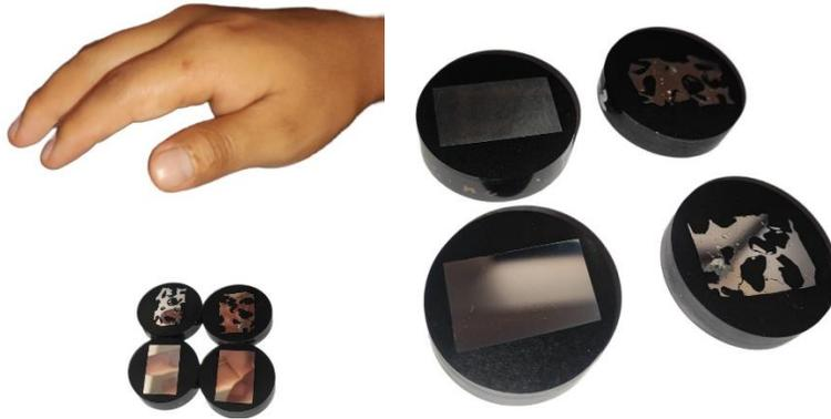
**Figura 2.18** Probetas listas para ensayo metalográfico
