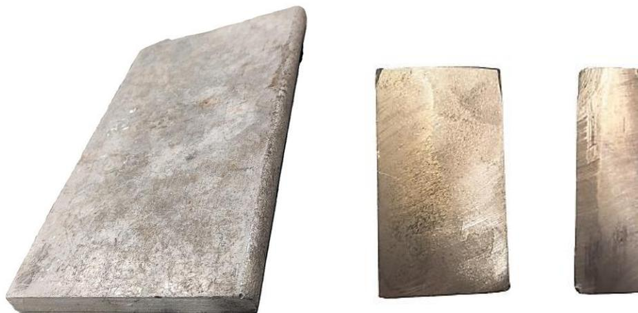
**Figura 2.14** Placa de aluminio y probetas individuales
