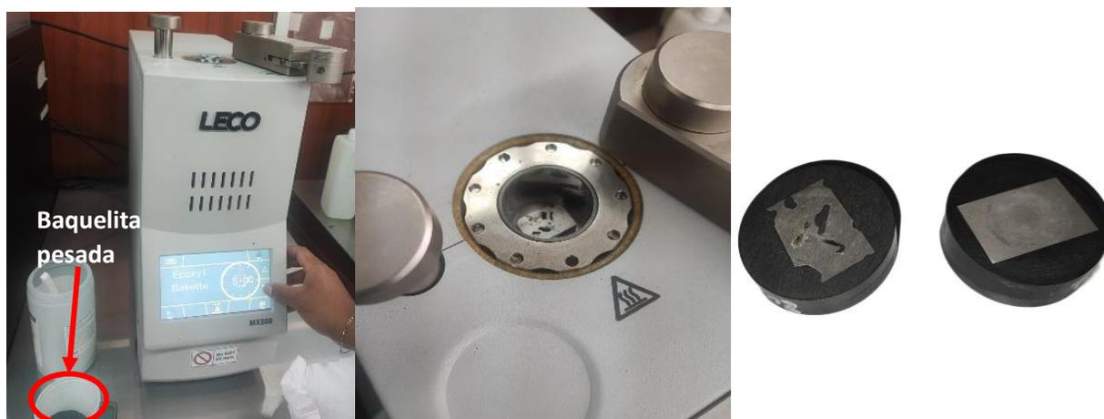
**Figura 2.16** Proceso de encapsulado de las probetas de aluminio
