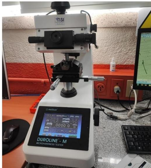
**Figura 2.8** Micro durómetro DUROLINE-M
