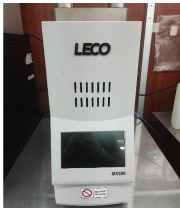
**Figura 2.3** Prensa de montaje en caliente LECO MX500
