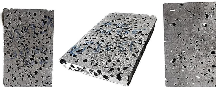
**Figura 2.11** Espuma metálica de aluminio rectificada
