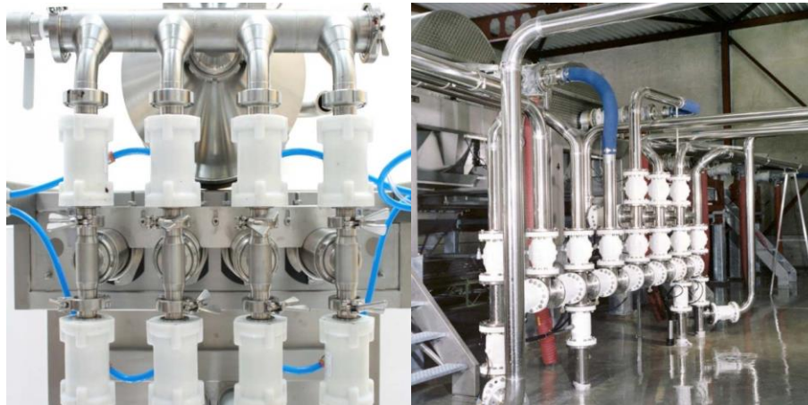
Figura 1.8. Válvula de pinzas en procesos alimenticios.
