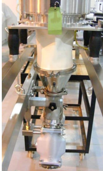
Figura 1.11. Proceso farmacéutico con válvula de pinzas
