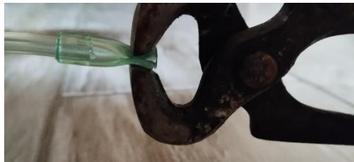
Figura 3.6. Estrangulación de manguito flexible experimento
