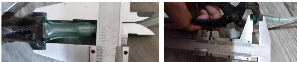
Figura 3.12 Área de contacto pinza y manguito de goma
