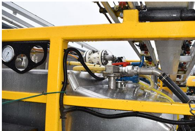
Figura 1.10. Dosificación de semillas y abono en la agricultura por válvulas de pinzas
