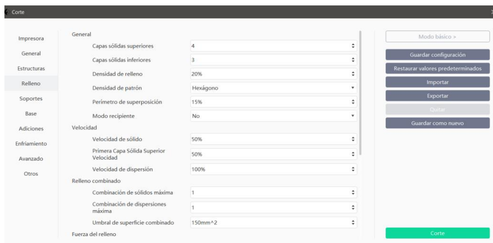
Figura 5.14. Configuración relleno impresión
