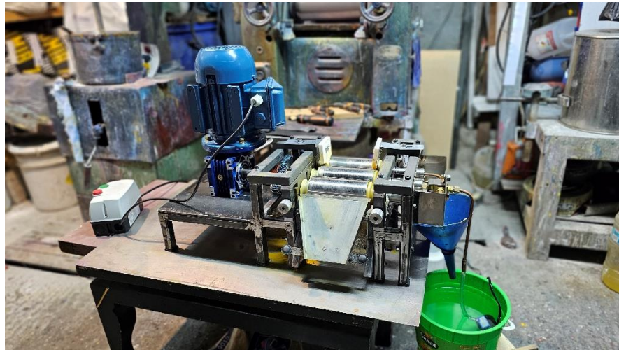
Figura 2.20. Molino tricilíndrico de pinturas ensamblado.
