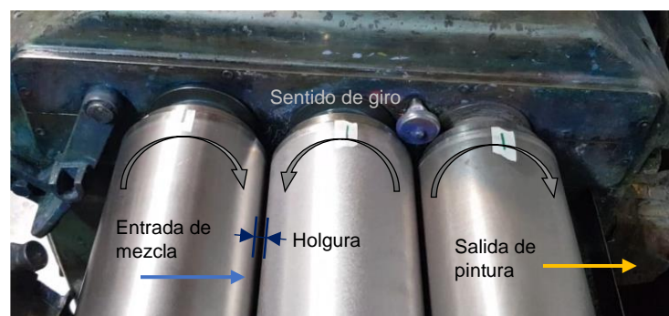
Figura 1.4.2. Rodillos de molienda para pintura al óleo.
