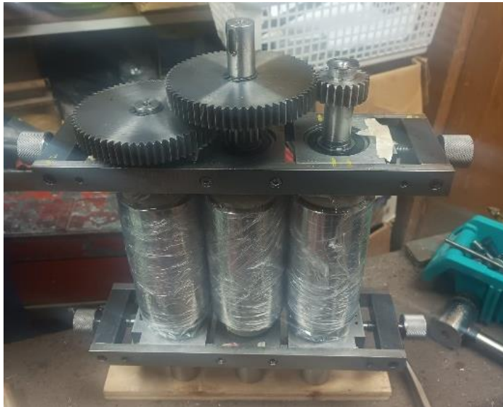
Figura 2.17. Montaje de engranajes, anillos de retención y acople del eje motriz.
