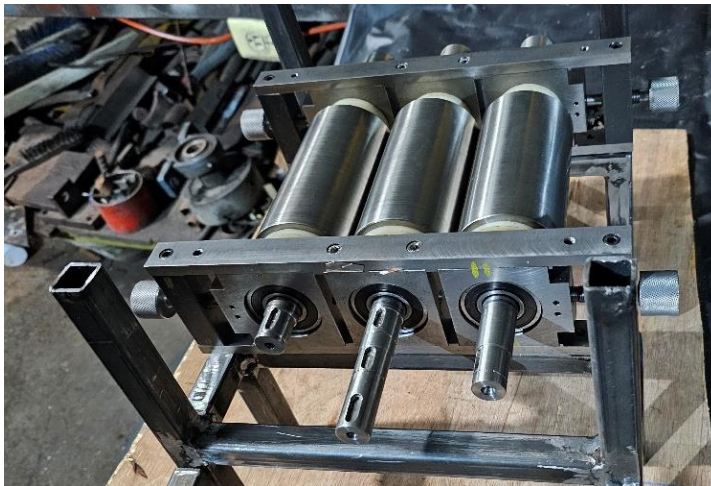
Figura 2.18. Montaje de canales laterales a rodillos y rieles en bastidor.
