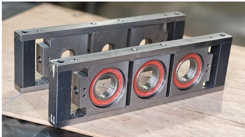
Figura 2.15. Montaje de rodamientos a cajas móviles.
