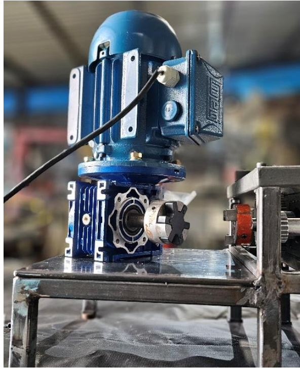
Figura 2.19. Montaje del reductor de velocidad al eje central.
