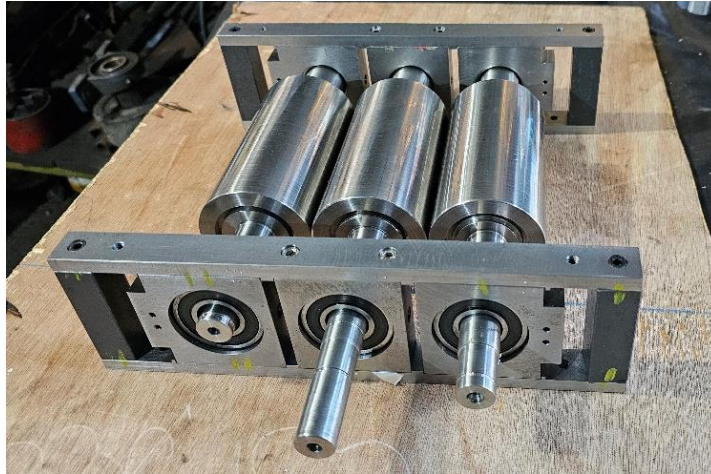
Figura 2.16. Montaje de rodillos.
