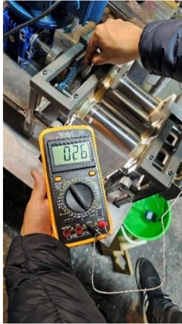
Figura 2.21. Temperatura de engranajes en operación sin carga.
