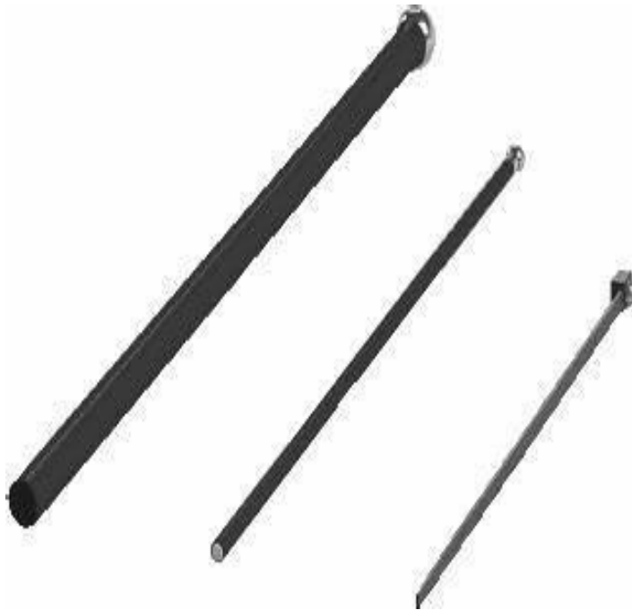
Figura 1.2 Dispositivos excitadores manuales (Sonelastic, 2023)
