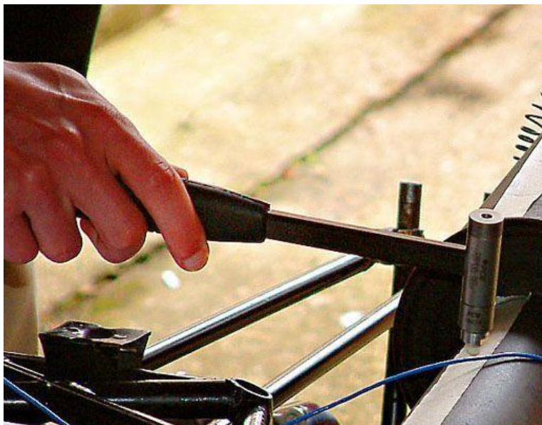
Figura 1.4 Martillo de impacto de uso manual para estudio de comportamiento de estructuras (DATS-HITS, 2023)
