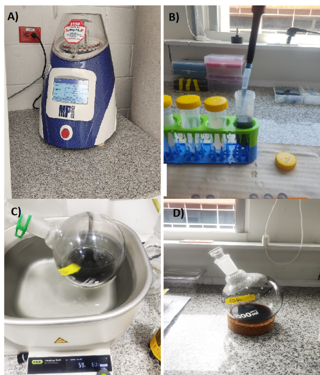
Figura 2.1: A) Sistema de lisis. B) Deposición del grafeno exfoliado en tubos Falcon. C) Rotaevaporación. D) Grafeno rotoevaporado listo para ser liofilizado.
