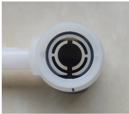
Figura 2.3: Disco de cuarzo con electrodos de oro.
