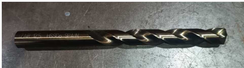
Figura 2.8 Broca Izar HSSCo 12.5mm de fabricación española (nueva). Fuente: Propia
