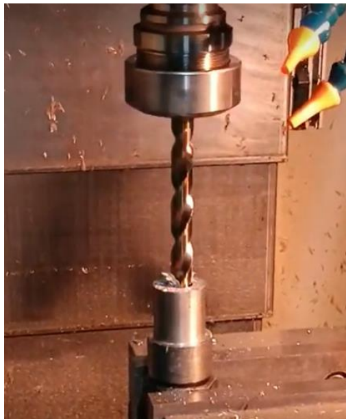
Figura 2.15 Proceso de mecanizado de las probetas a través de taladrado. Fuente: Propia.
