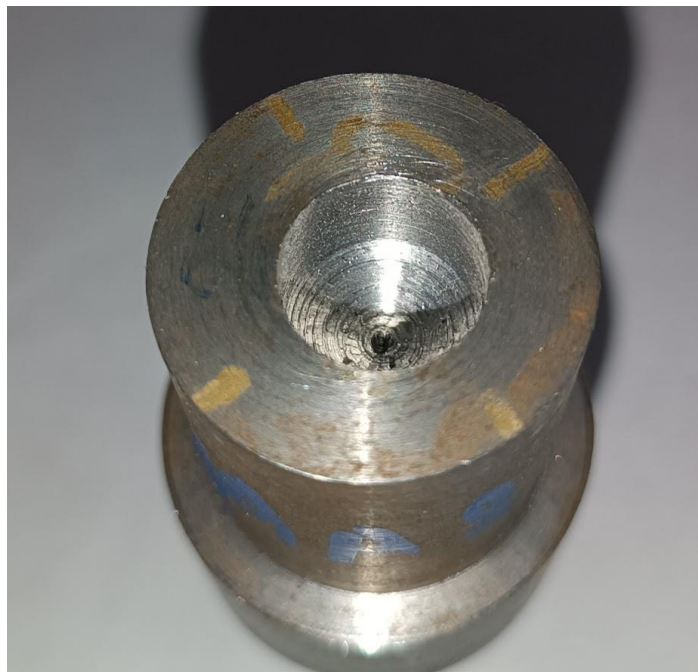
Figura 3.12 Probeta VMAA2 con peor acabado superficial. Fuente: Propia
