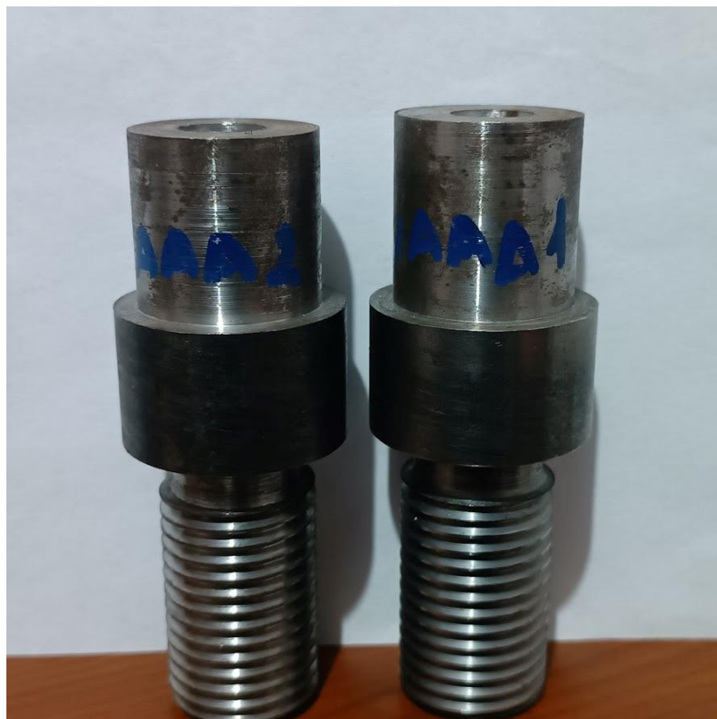
Figura 3.3 Probetas con menor tiempo de mecanizado VAAA1 (izq.) y VAAA2 (der.). Fuente: Propia.
