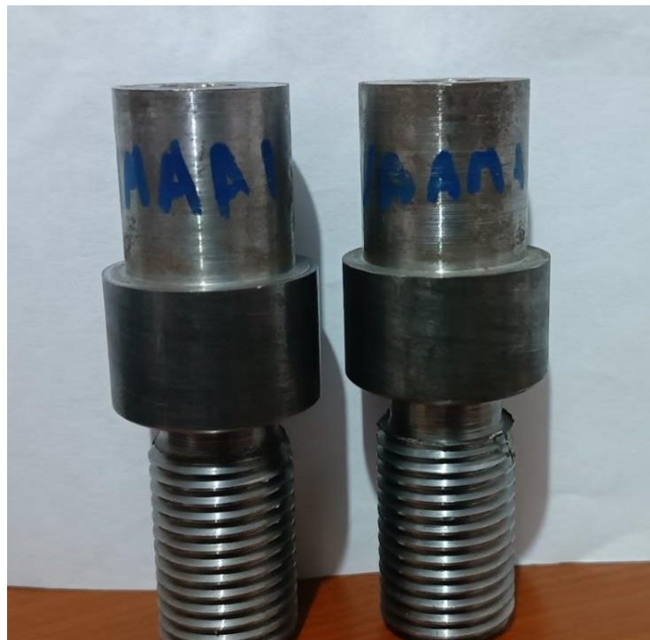
Figura 3.6 Probetas con menor y mayor error relativo en su diámetro, VMAA1 (izq) y VAAM1 (der). Fuente: Propia
