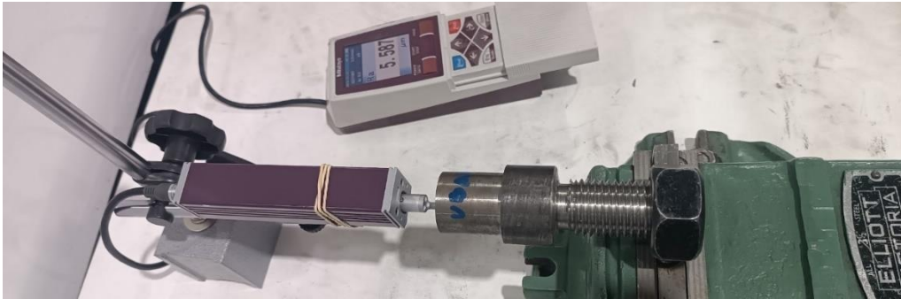
Figura 2.16 Medición de una probeta con el rugosímetro Mitutoyo. Fuente: Propia.
