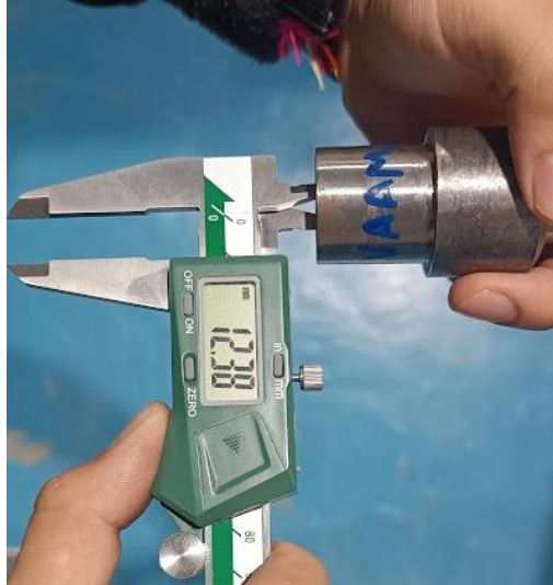
Figura 2.17 Medición de diámetro en las perforaciones de las probetas. Fuente: Propia
