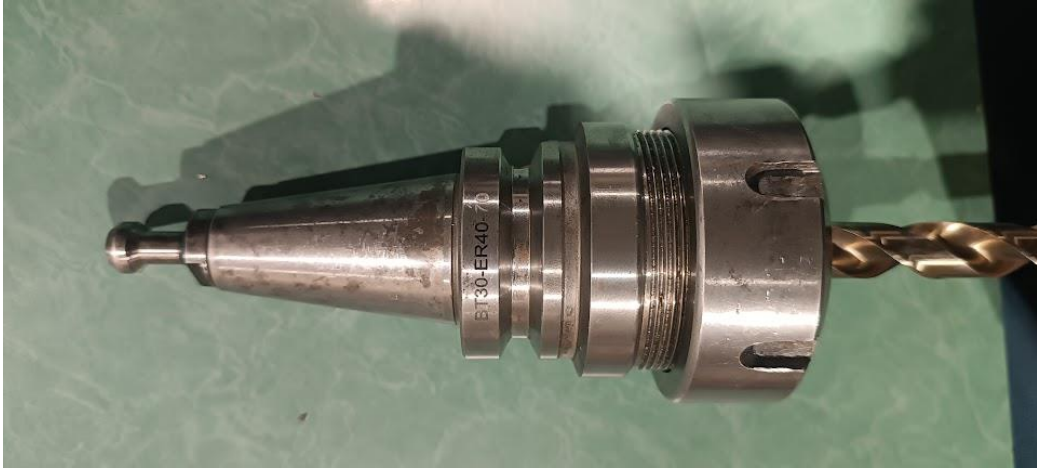
Figura 2.6 Herramienta de sujeción en conjunto con la broca. Fuente: Propia
