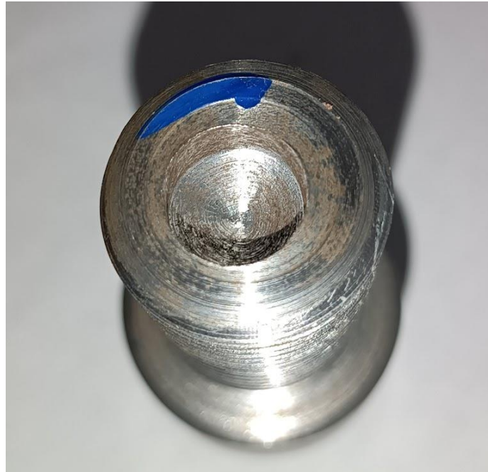
Figura 3.7 Probeta con tolerancia H7, VMAA1. Fuente: Propia
