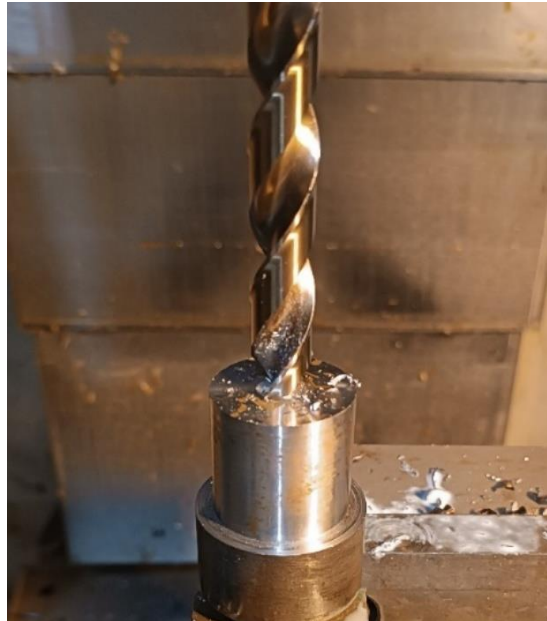
Figura 2.10 Prueba inicial con parámetros brindados por el fabricante, momento en el cual la broca se atasca en la probeta. Fuente: Propia
