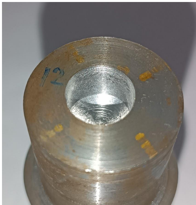
Figura 3.13 Probeta VAAA1 con mejor acabado superficial. Fuente: Propia
