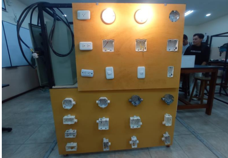
Figura 3.16 Circuito 2 implementado en el módulo de canalizaciones
