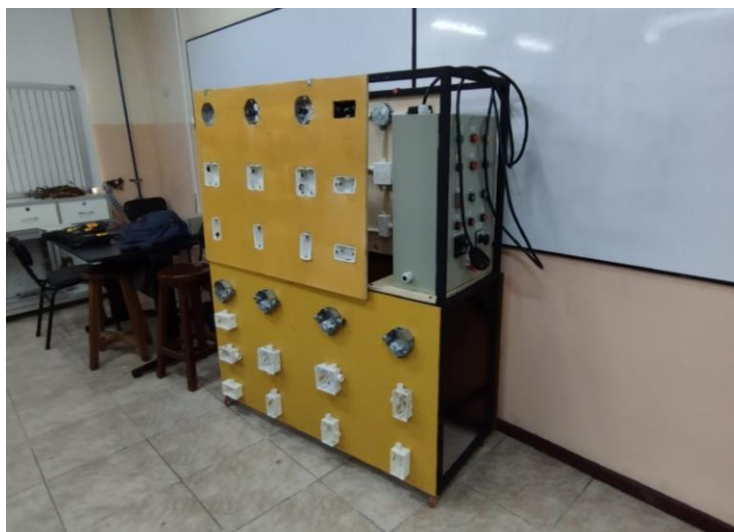
Figura 3.11 Módulo de entrenamiento para canalizaciones eléctricas
