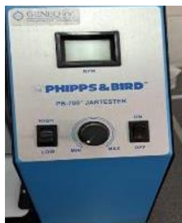
Figura 10. Panel de control del equipo PHIPPS & BIRD MODELO PB-700.
