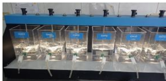
Figura 9. Prueba de Jarra equipo PHIPPS & BIRD MODELO PB-700
