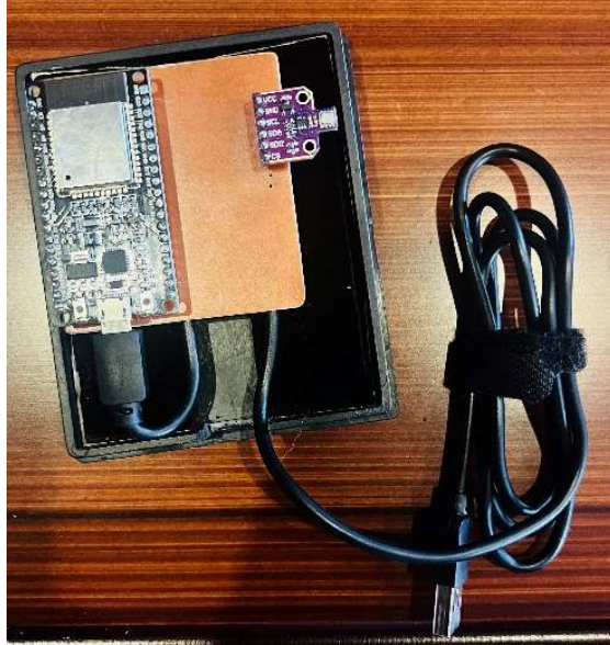
Figura 3.20. Prototipo en la caja de protección.
