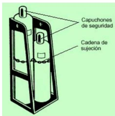
**Figura 1.1** Plataforma de transporte para los recipientes de gases, [1]
