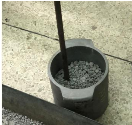
Figura 6: Varillado del agregado grueso
