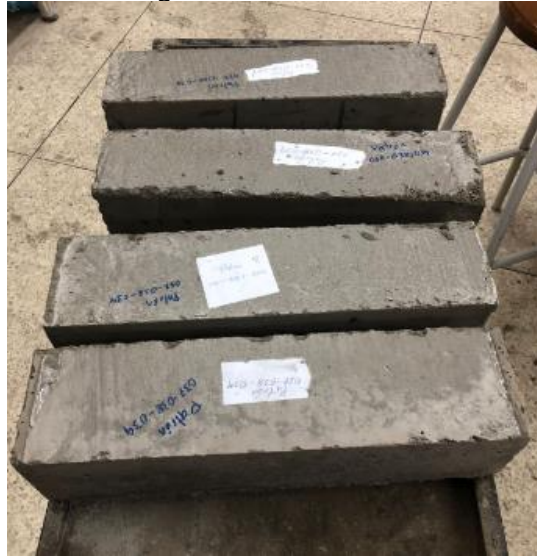
Figura 26: Desencofrado de las vigas
