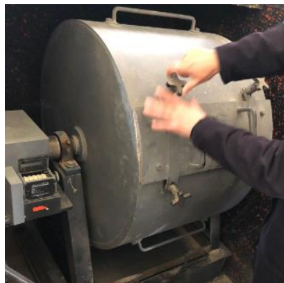
Figura 8: Ensayo de abrasión del agregado grueso
