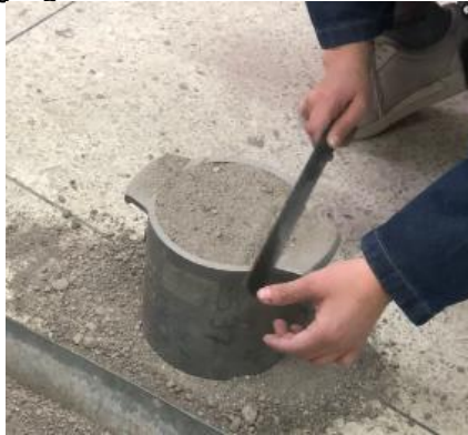
Figura 11: Enrasado del agregado fino
