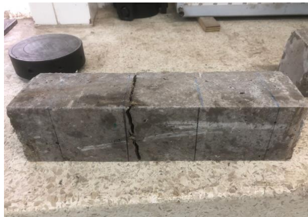
Figura 33: Rotura de una viga por ensayo a flexión
