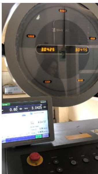
Figura 29: Registro de datos del ensayo a flexión en vigas
