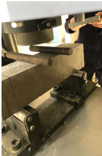
Figura 28: Preparación de la viga para el ensayo a flexión
