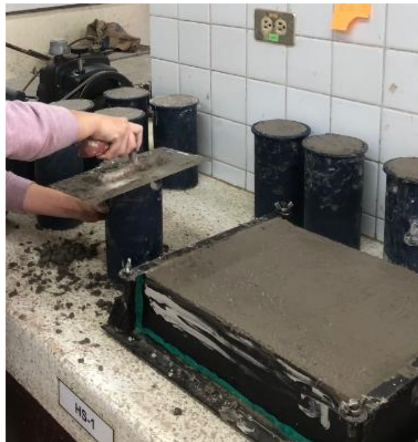
Figura 25: Encofrado de cilindros y vigas
