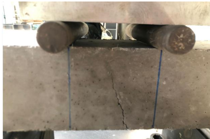
Figura 33: Rotura de una viga por ensayo a flexión
