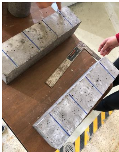
Figura 27: Marcado de las vigas para el ensayo de flexión
