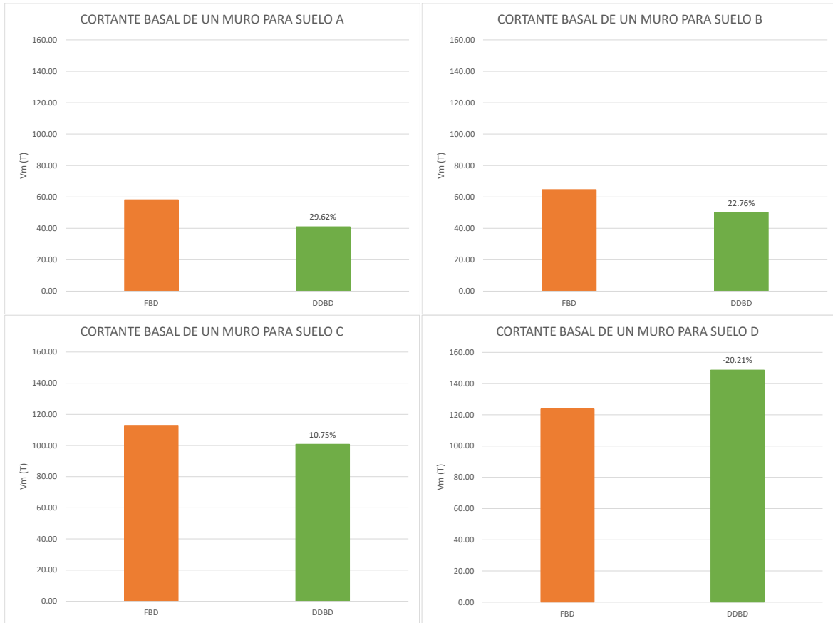
Figura 3.11. Comparación de cortante basal por DDBD y FBD para distintos tipos de suelo.
