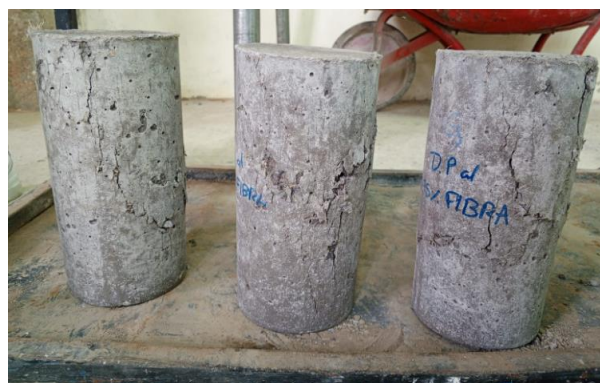
Figura 17. Ensayo a Compresión
