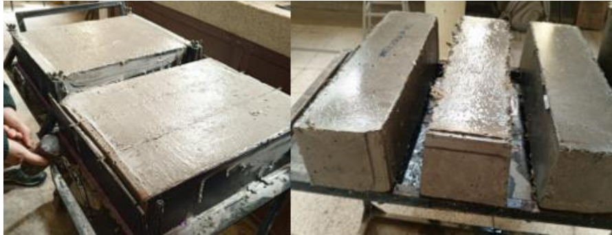
Figura 16. Preparación y Curado de Vigas
