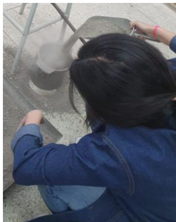
Figura 9. Densidad Aparente Suelta y Compactada
