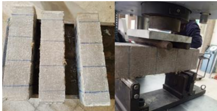
Figura 18. Ensayo a Flexión
