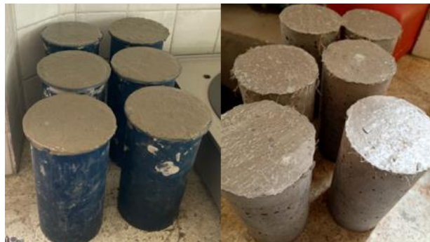
Figura 15. Preparación y Curado de Cilindros
