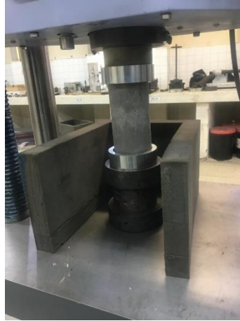
Figura 12. Proceso de ensayo a compresión (realizado en el laboratorio LEMSUR, EPN).
