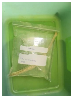
Figura 6. Fibra de 21 cm de longitud en tratamiento con NaOH
