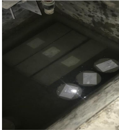
Figura 11. Proceso de curado de las probetas, (vigas y cilindros).
