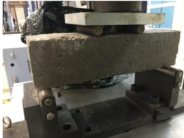
Figura 15. Representación gráfica del ensayo a tracción en vigas.
