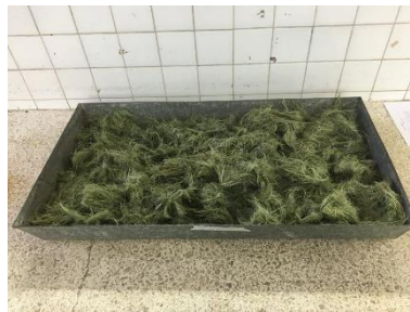
Figura 8. Fibra de 4 cm de longitud después del tratamiento con NaOH y secado al horno
