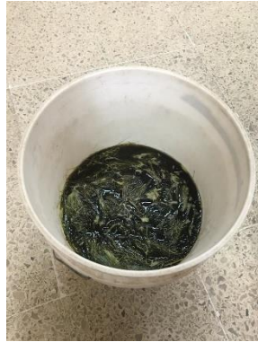
Figura 7. Fibra de 4 cm de longitud en tratamiento con NaOH
