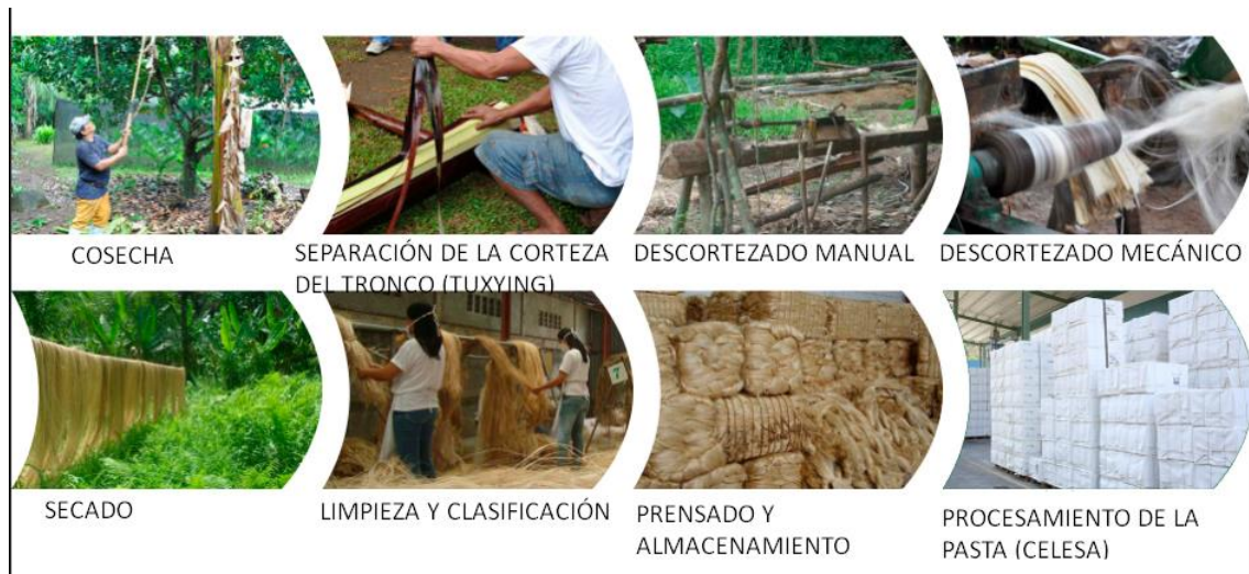
Figura 5. Proceso de extracción de la fibra de abacá.
