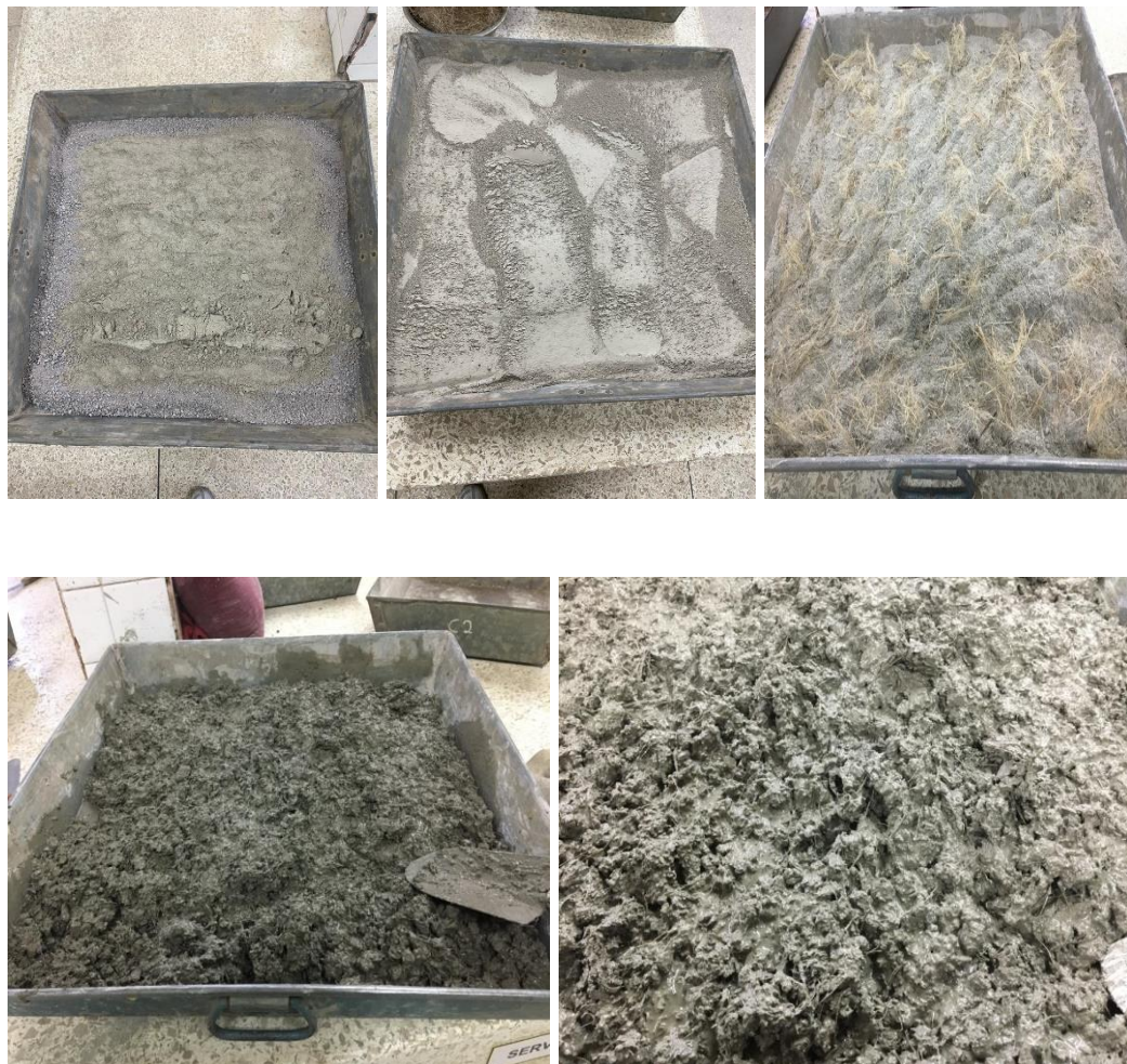
Figura 10. Proceso de elaboración del hormigón.
