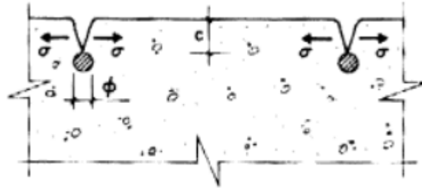
Figura 3. Representación de fisuras por acomodamiento plástico.
