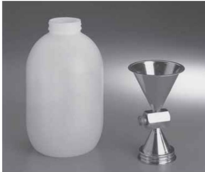
Figura 8. Equipo para ensayo de Cono y arena
