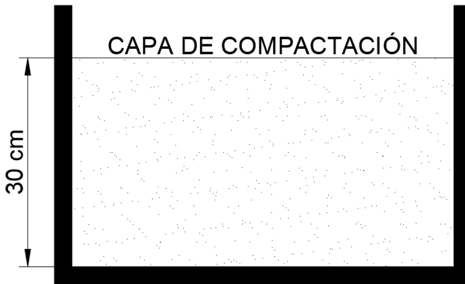
Figura 31. Capa de compactación
