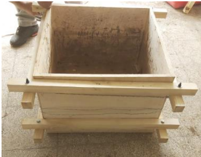
Figura 25. Reforzamiento lateral con alfajías de madera de la caja de compactación
