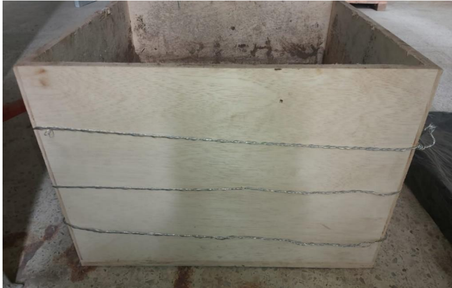
Figura 24. Reforzamiento lateral con alambre de la caja de compactación
