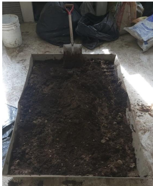
Figura 29. Preparación del contenido de humedad en el suelo
