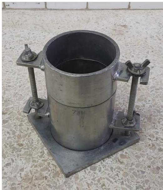
Figura 20. Molde de compactación
