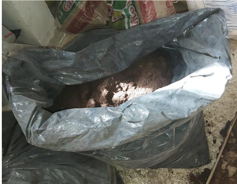
Figura 30. Enfundado de la masa de suelo para conservación
