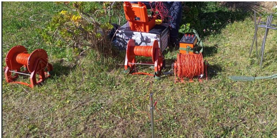
Figura 10. Equipo de medición del nivel freático.
