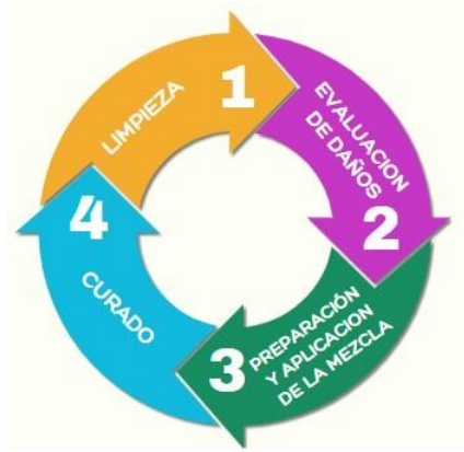
Figura 30. Esquema reparación de ladrillo refractario. (Fuente: Propia)
