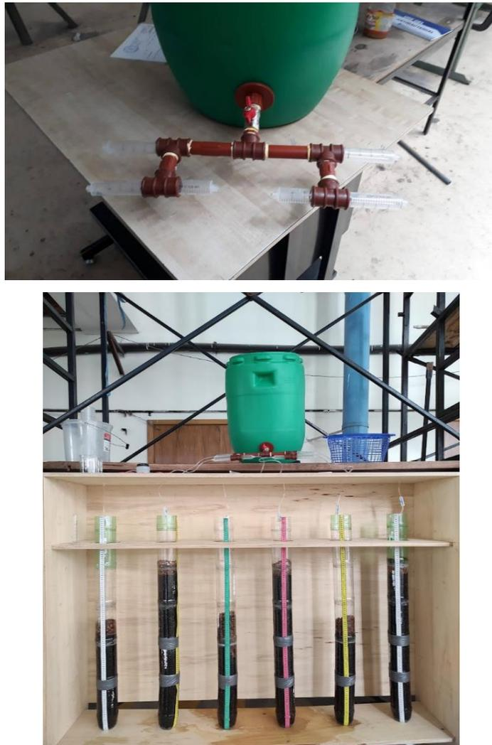
**Figura 2.** Tanque de distribución y sistema de biofiltración
