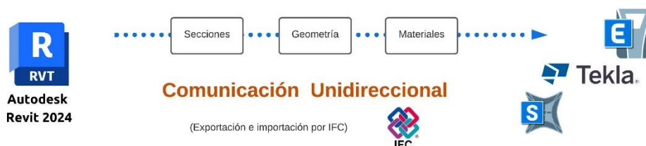
Figura 1.5 Interoperabilidad unidireccional mediante Indirect link
