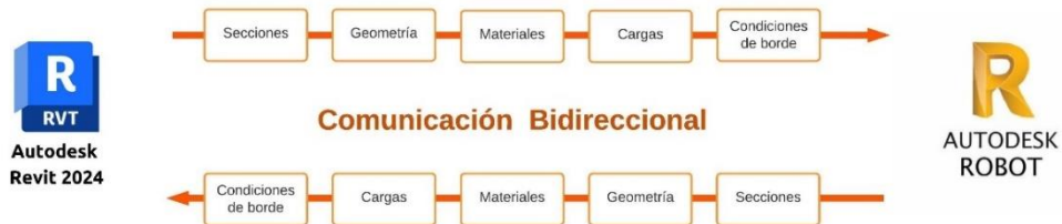
Figura 1.4 Interoperabilidad bidireccional mediante direct link
