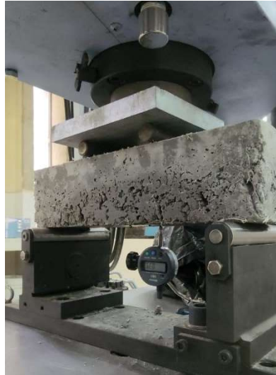
Figura 20. Ensayo a flexión en viga con carga aplicada en los tercios
