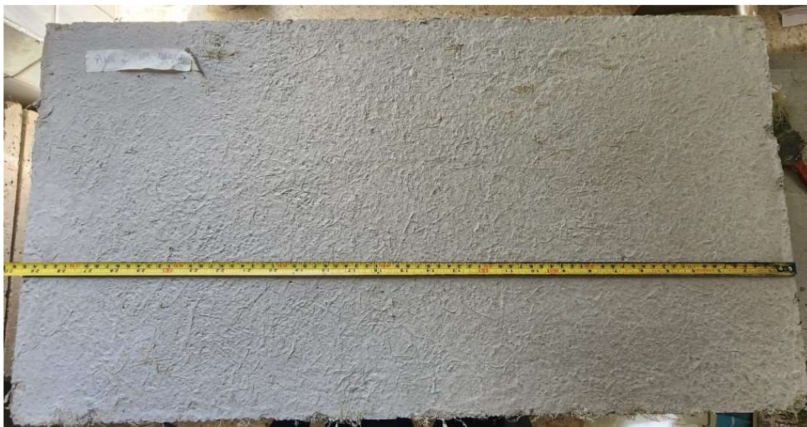
PLACA 02-CF-1%. NO MUESTRA AGRIETAMIENTO
