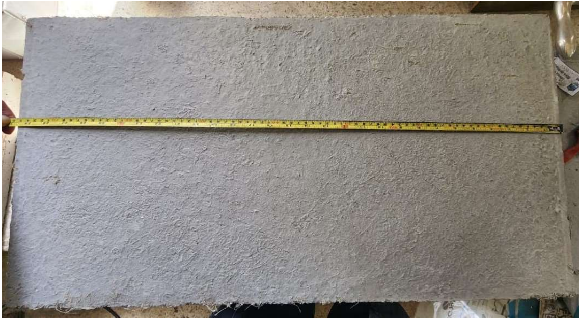
PLACA 05-CF-1%. NO MUESTRA AGRIETAMIENTO
