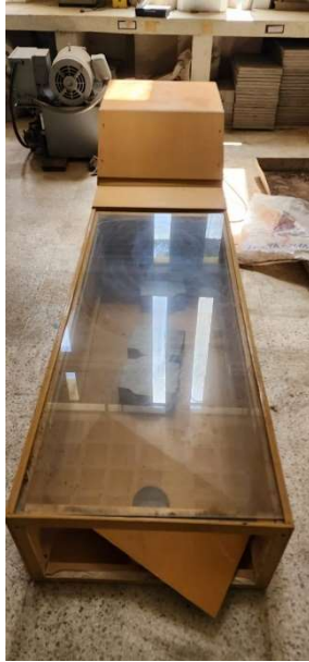
Figura 21. Cámara de aire caliente para evaluación de losas de hormigón
