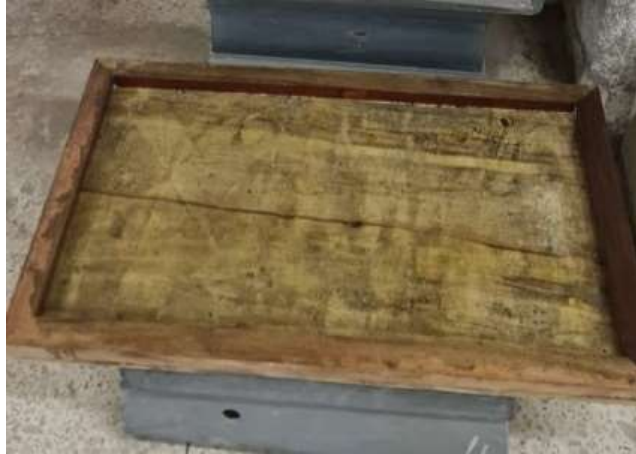
Figura 16. Encofrado de madera para probetas tipo placa
