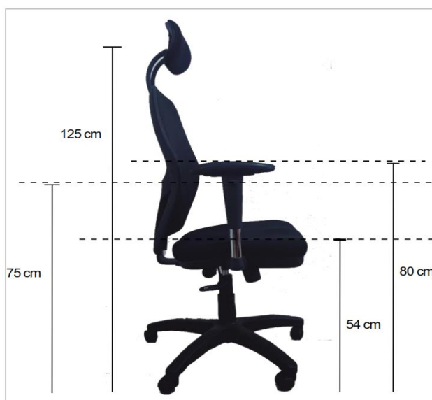
Figura 3.13. Plano lateral y medidas de silla ergonómica en altura máxima
