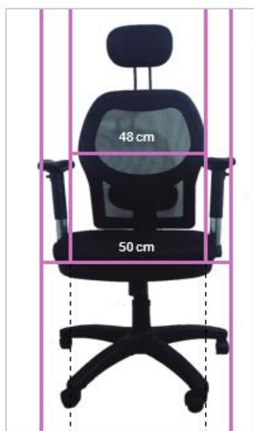
Figura 3.15. Plano frontal de silla ergonómica y medidas horizontales
