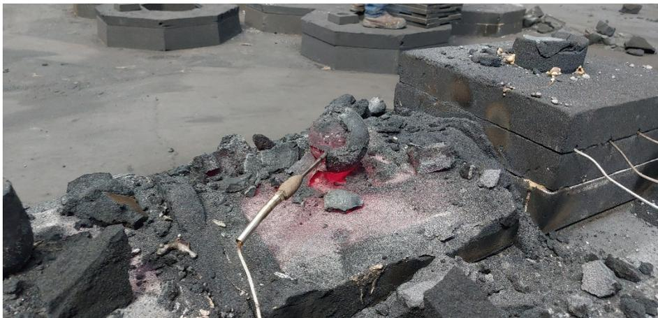
Figura 4.1. Esquema del registro de temperaturas durante el proceso de fundición. a) Ubicación de los moldes durante el colado y b) Pieza en proceso de solidificación en la que se usó una mazarota con camisa exotérmica de forma esférica, adicionalmente se aprecia el termopar en contacto con la mazarota.
