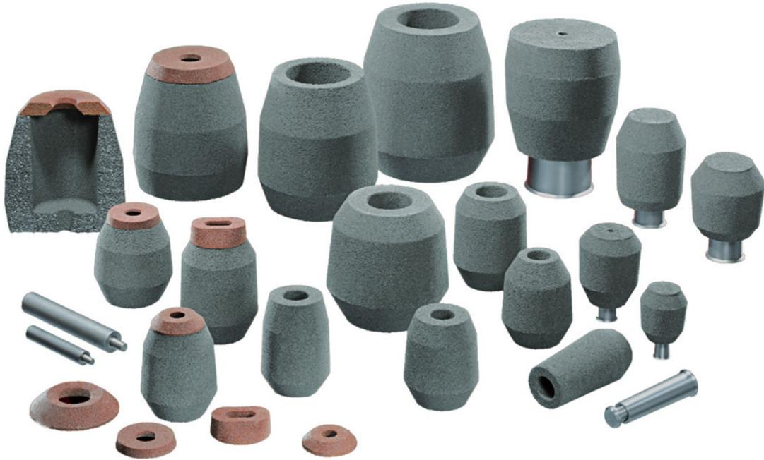
Figura 1.1. Esquema de diferentes formas y tamaños de camisas exotérmicas. *Los elementos de color rojizo corresponden a elementos de adaptación (cuello) que permiten la correcta conexión con el sistema alimentación hacia la pieza [55].*
