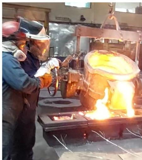
Figura 2.18. Esquema de procedimiento para la ejecución de pruebas definitivas. a) Elaboración de moldes para la fabricación de las camisas exotérmicas, b) Fabricación de las camisas exotérmicas, c) Moldeo de la caja y colocación de la camisa y termopares para registro de temperaturas, y d) Fundición de las piezas y registro de temperaturas.
