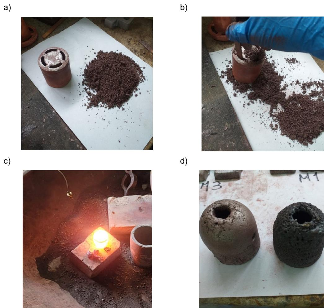
Figura 2.16. Esquema de realización de pruebas piloto. a) Obtención del compuesto exotérmico previo a la elaboración de la camisa, b) Fabricación de la camisa exotérmica mediante moldeo en la caja de noyos, c) Pruebas de activación y evaluación de la temperatura producida en la camisa, y d) Comparativa entre una camisa exotérmica no activada (izquierda) con respecto a una camisa luego de su activación (derecha).
