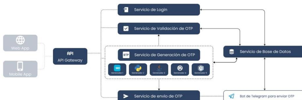
**Figura 2.** Arquitectura del componente del prototipo de sistema de One-Time Password (OTP) para un sistema de autenticación de dos factores, usando generadores de OTP basados en TRNG y enviados mediante Telegram.
