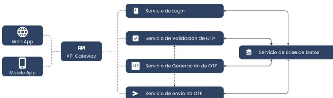
**Figura 1.** Arquitectura general del prototipo de sistema de One-Time Password (OTP) para un sistema de autenticación de dos factores orientado a microservicios.
