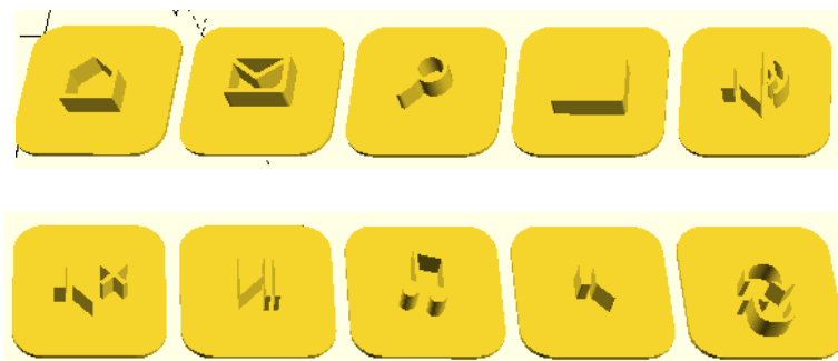
Figura 2.8 Teclas multimedia de teclado Meotion diseñadas con OpenSCAD.
