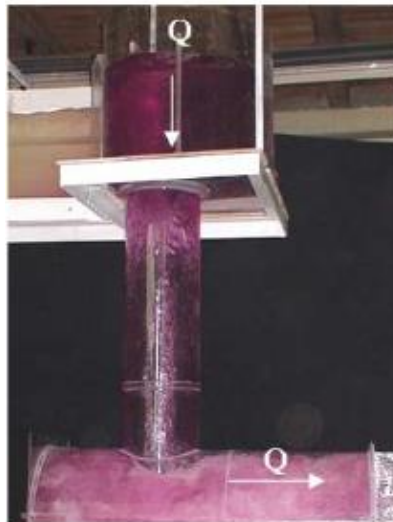
Figura 2.29 Tubo de descargador a vórtice Fuente: Haro y Jara (2006)
