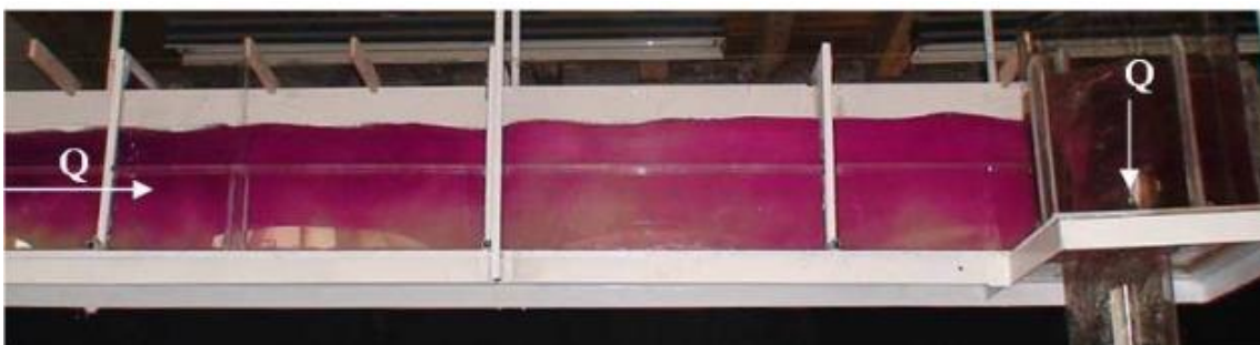
Figura 2.26 Canal de aproximación del vórtice de descarga
