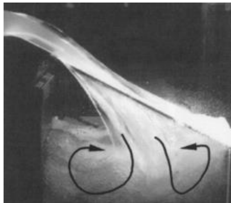
Figura 2.21 Formación de vórtices en el canal de admisión
