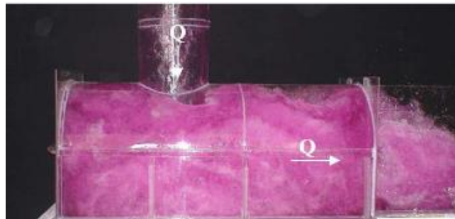
Figura 2.30 Cámara de disipación
