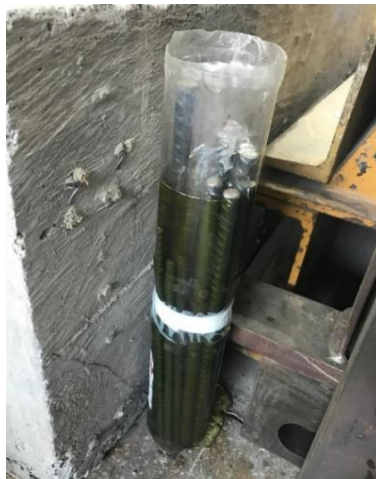
Figura 2.24 Desoxidación de varillas
