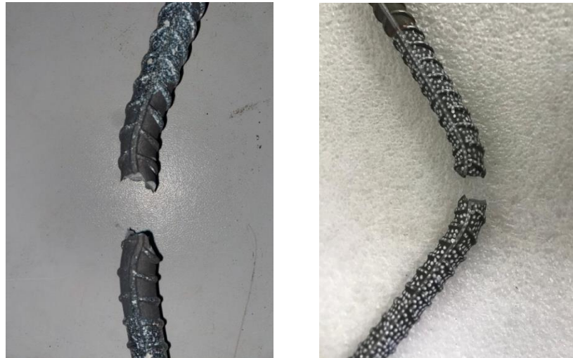
Figura 2.11 Detalle de rotura de la varilla
