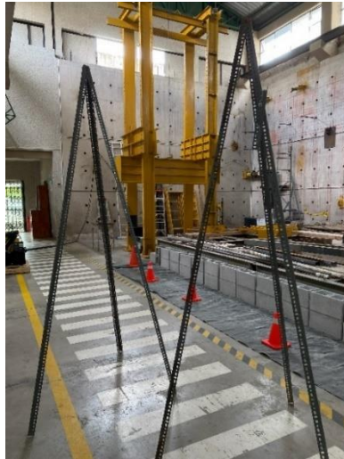
Figura 2.23 Estructuras de perfiles de acero para soporte de celular y lámparas
