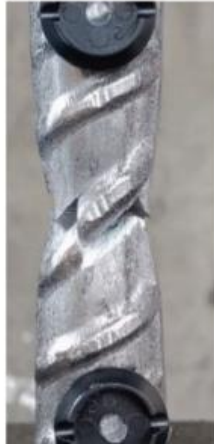
Figura 1.7 Detalle falla dúctil
