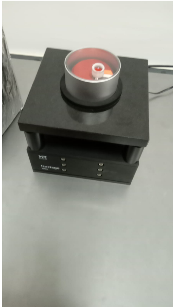
Figura A.7: En esta imagen se observa el STM de la marca NanoSurf, la cual, se encuentra sobre una mesa antivibratoria electrónica y ambos están sobre otra mesa antivibratoria mecánica.
