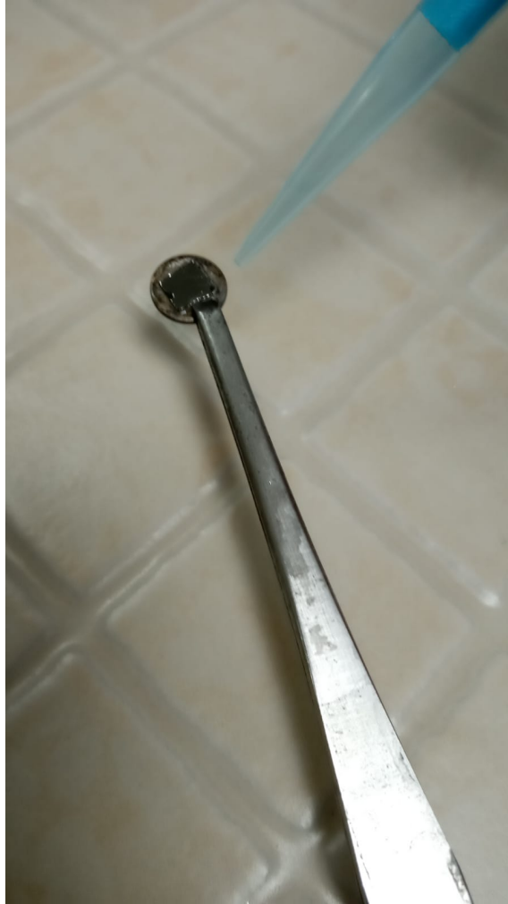
Figura A.3: Proceso de secado con gas N_2
