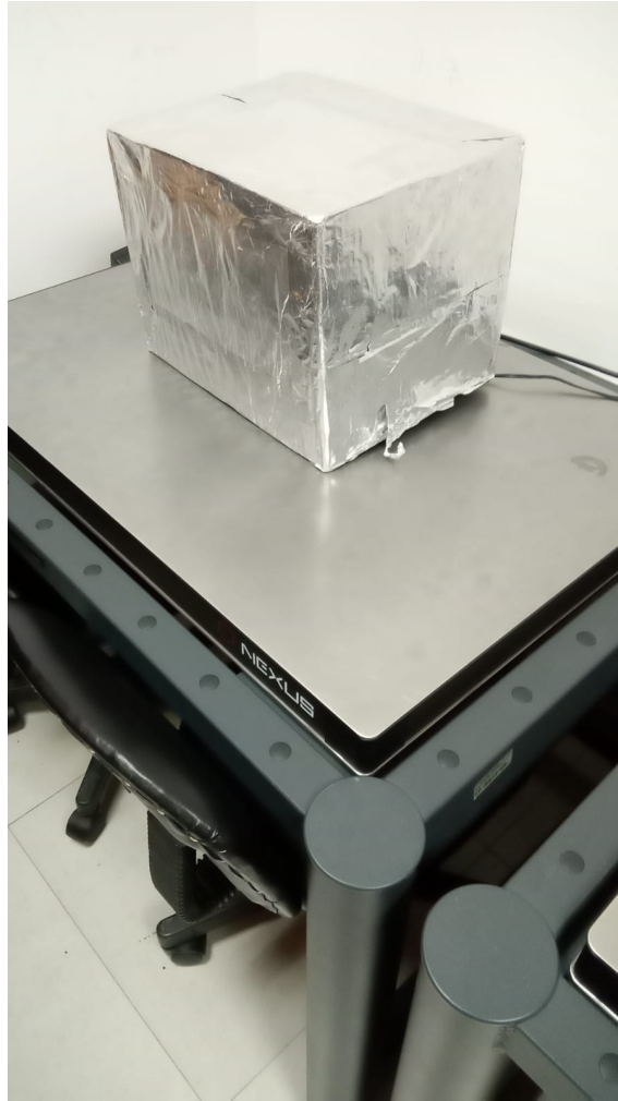
Figura A.9: Cubierta de aluminio para el STM que evita la propagación de ruidos electrónicos.
