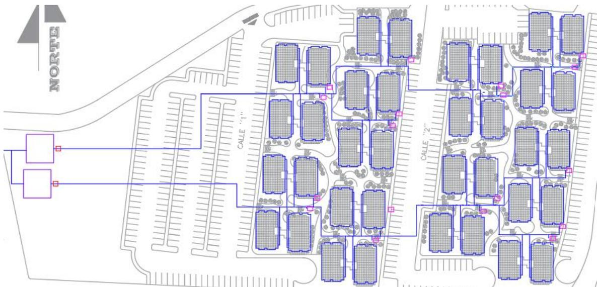
**Figura 2.9.** Trazado de red de agua fría externa para los edificios
