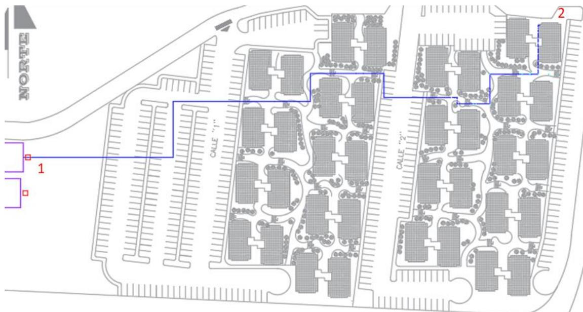
**Figura 2.10.** Trazado de tubería desde cisterna hasta grifo más desfavorable
