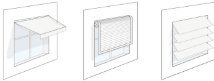
Figura 1.11 Tipos de dispositivos de protección solar exteriores [6]
