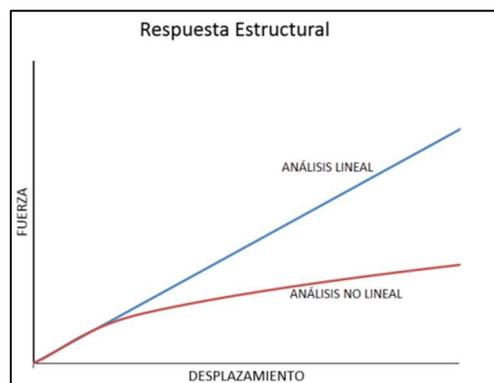
**Figura 1.14:** Respuesta estructural análisis lineal - no lineal
