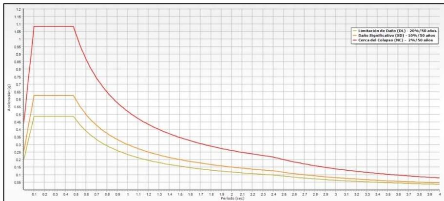
**Figura 2.88:** Espectro de diseño para Colombia sismos de 20%, 10% y 2% de excedencia
