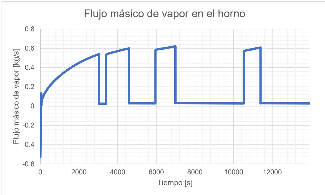
Figura 3.10 Flujo de vapor que entrega la caldera durante el ciclo de cocción Fuente: (Propia)
