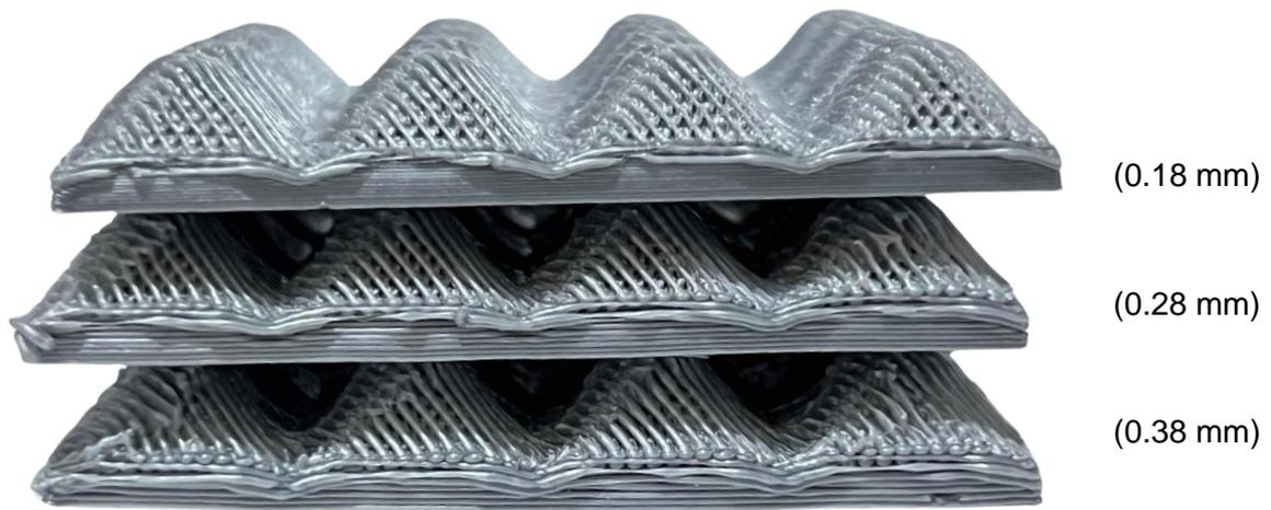
**Figura 34** Vista lateral del Modelo T2 impreso a diferentes alturas de capa. [Propia]
