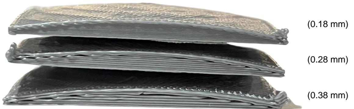
**Figura 32** Vista lateral del Modelo T1 impreso a diferentes alturas de capa. [Propia]
