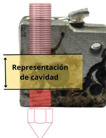
**Figura 14** Representación de la cavidad existente dentro del bloque calefactor vertical entre los finales de rosca de la boquilla y el dissipador. [Propia]
