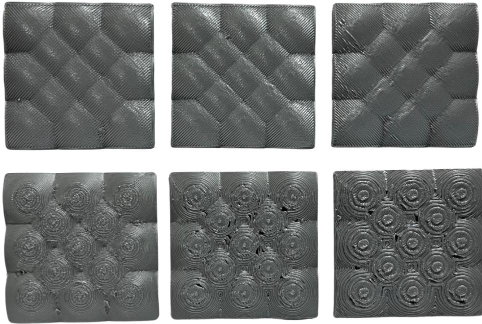
**Figura 39** Comparación del modelo T3, impresa de manera planar y no planar. [Propia]
