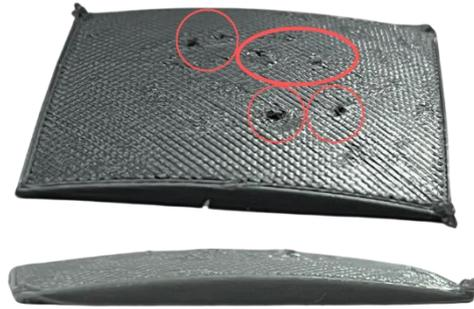
**Figura 26** Errores de impresión con altura de capa 0.1 mm. [Propia]
