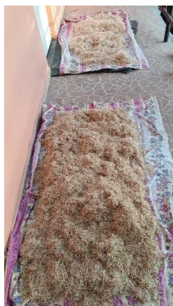
Figura 21. Secado al aire libre del BCA tratado con agua hervida
