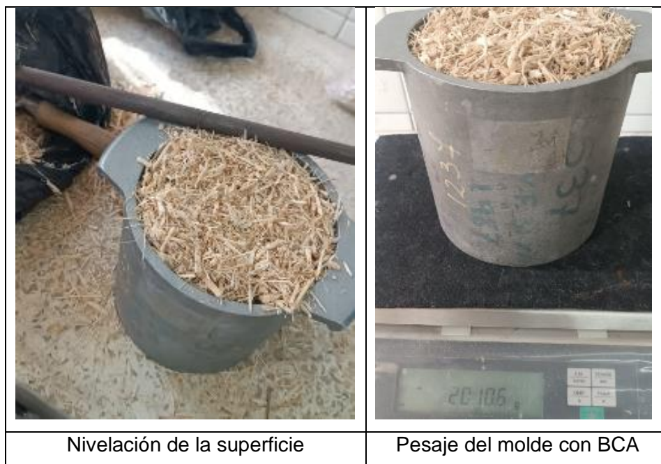
Figura 23. Determinación de densidad aparente de agregados
