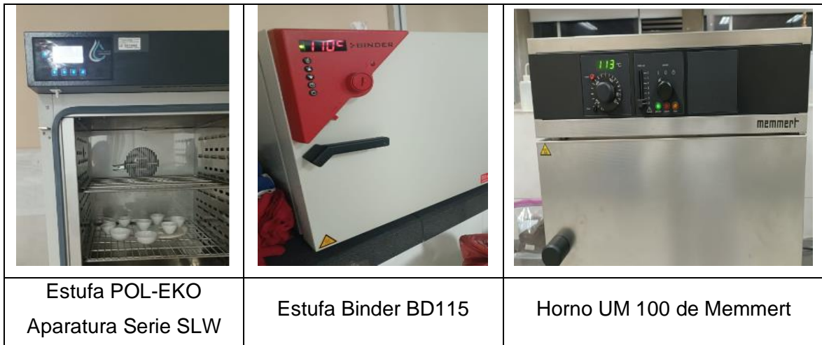
Figura 22. Secado final del BCA en las cuatro estufas de laboratorio
