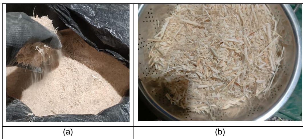
Figura 19. Tamizado del material particulado fino. (a) Presencia de material extrafino, y (b) Separación del material mediante tamiz metálico
