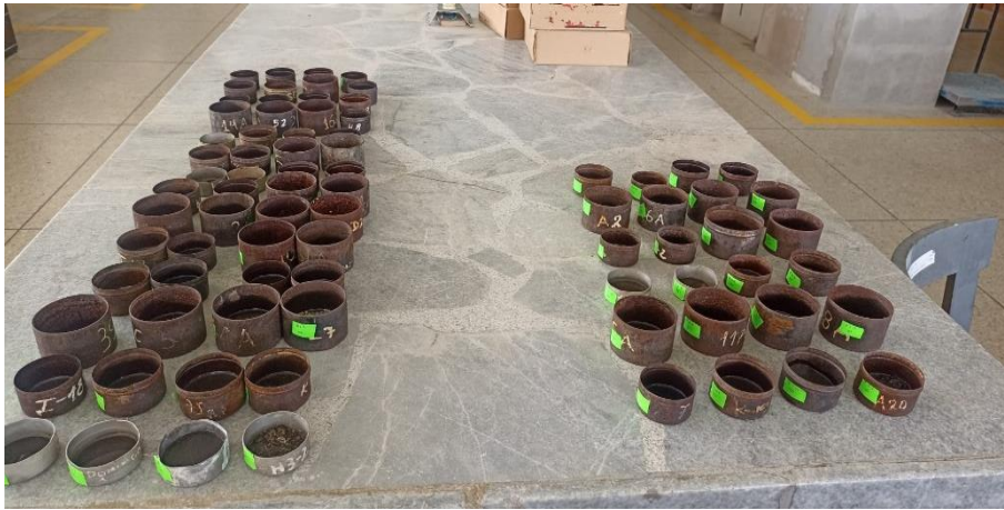
Figura 14. Muestras restantes de los tamices para ser secadas. Tomada por: Quishpe, B (2023).
