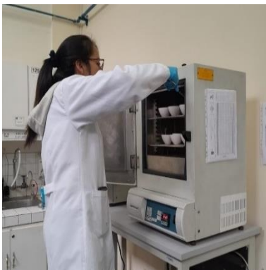
Figura 12. Conservación de las muestras en el desecador.
