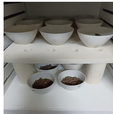
Figura 13. Calcinación de las muestras en la mufla.
