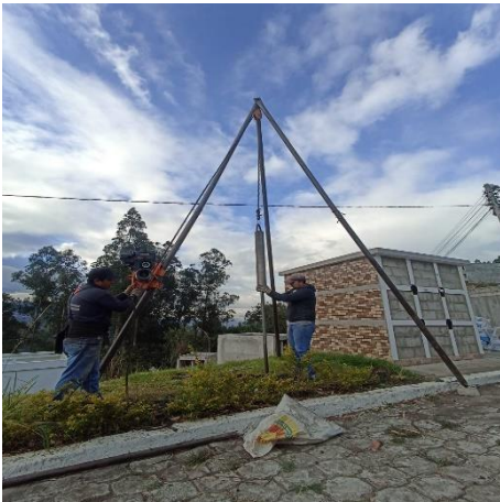
Figura 7. Trípode del equipo de penetración. Tomada por: Quishpe, B (2023).
