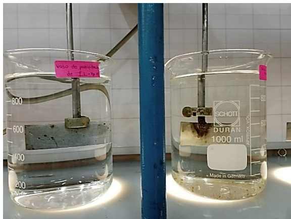
ANEXO XXXVIII. Visualización de la diferencia entre la jarra con el agua clarificada y la jarra del agua cruda.
