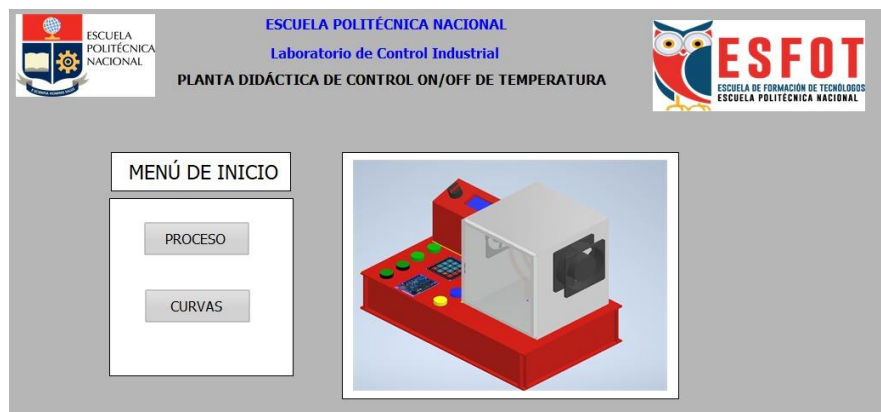
Figura 2.21 Ventana principal de la HMI.
