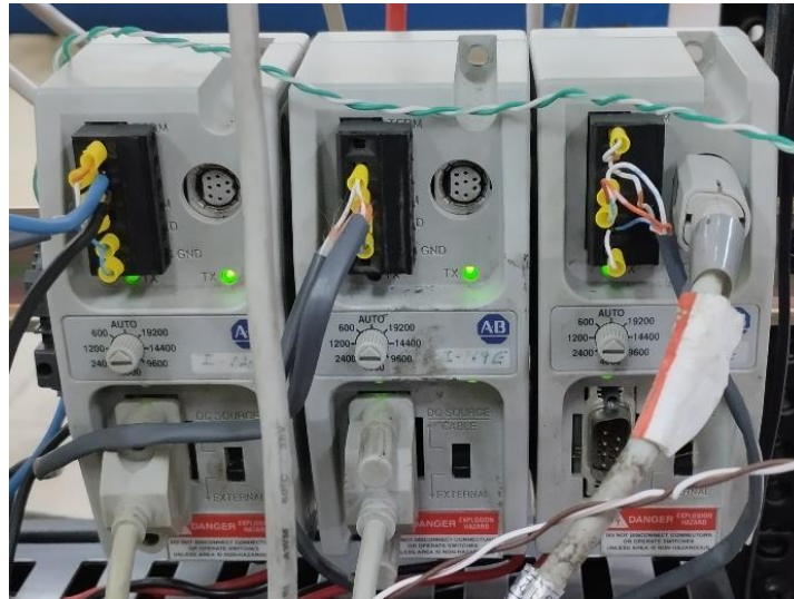
Figura 3.16: Red serial de convertidores avanzados de interfaz
