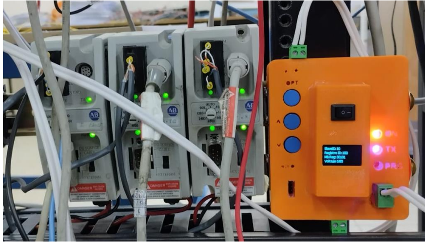
Figura 3.18. Comunicación del prototipo en una red Modbus
