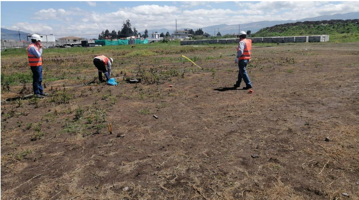
**Figura 3.7.** Toma de datos de resistividad del terreno para el área del centro de transformación
