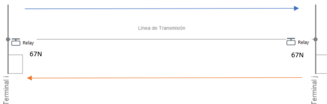
Figura 2.7. Protección del Relé 67N.
